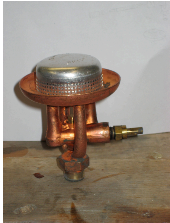
Abbildung 1: Zeichnung und Foto eines Optimus 207B Brenners sowie aktuelles Nachfolgemodell
