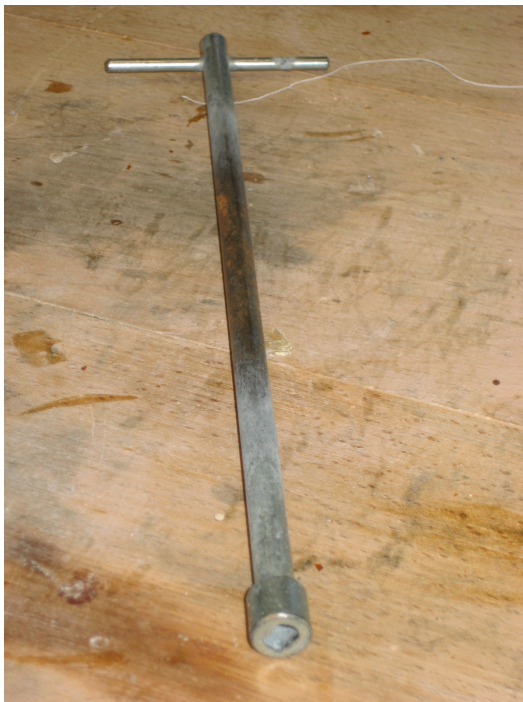
Abbildung 12: Schlüssel für Düse (Part 2561) und Bodenventil (links) sowie Düsennadel (rechts)
